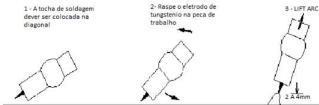
Figura 5 - Método para abertura de arco com Lift Arc.
