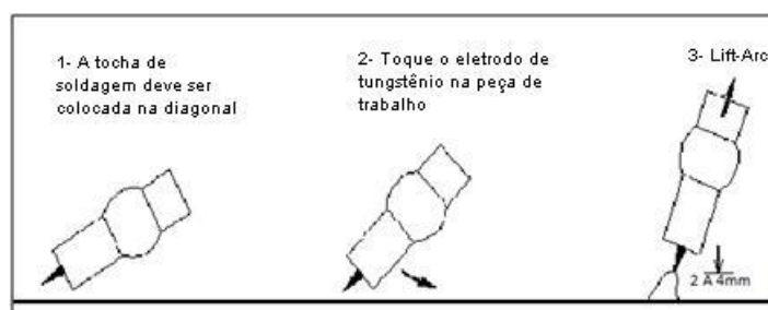
Figura 2: Método de abertura de arco com Lift Arc
