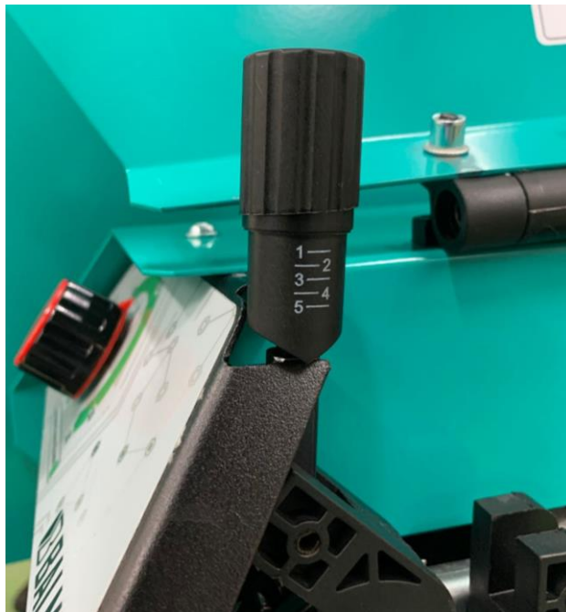
Figura 9 – Fixação do manípulo do cabeçote Vulcano MIG 465.
