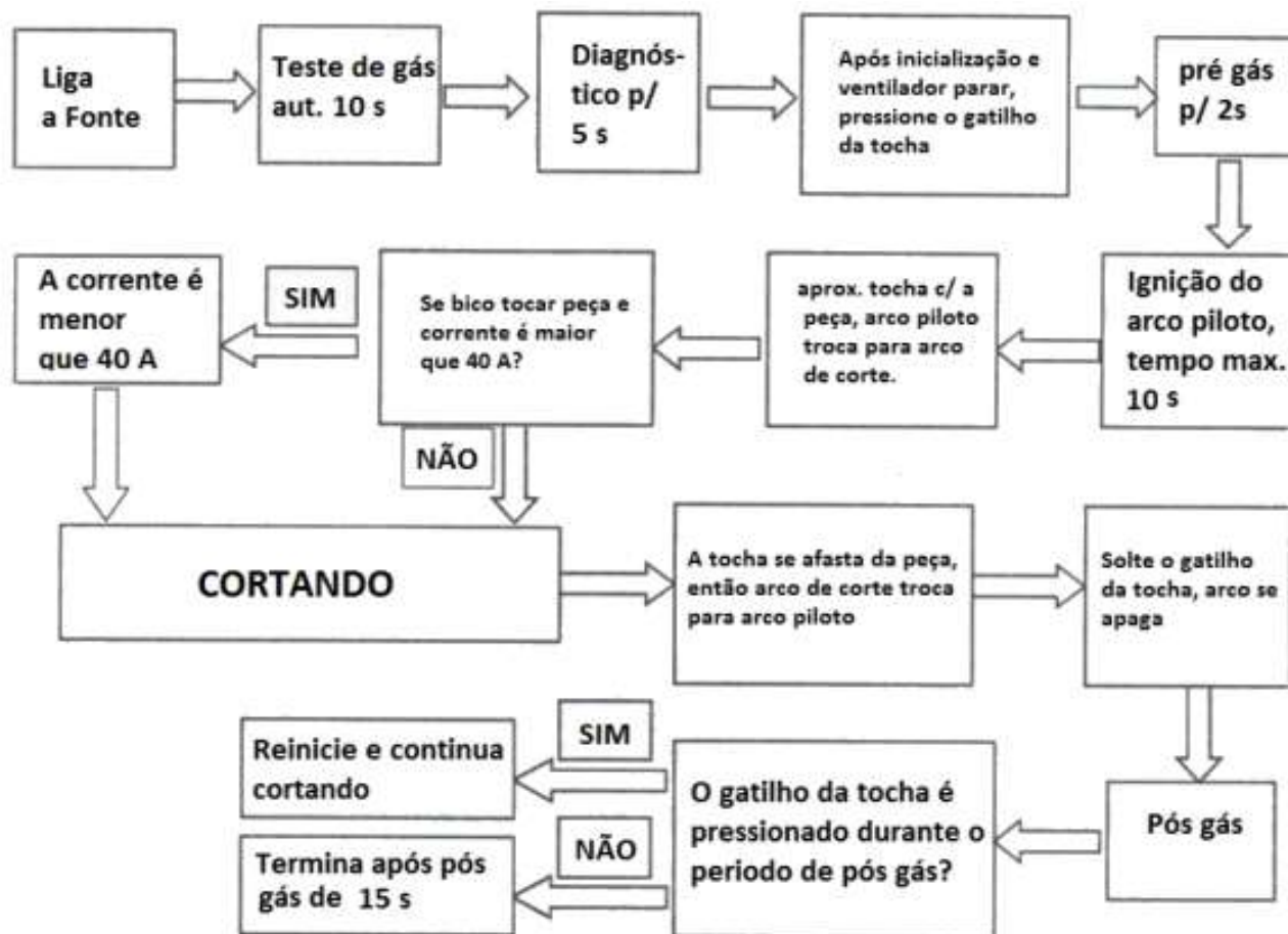
Figura 7 – Diagrama de blocos passo a passo corte normal.
