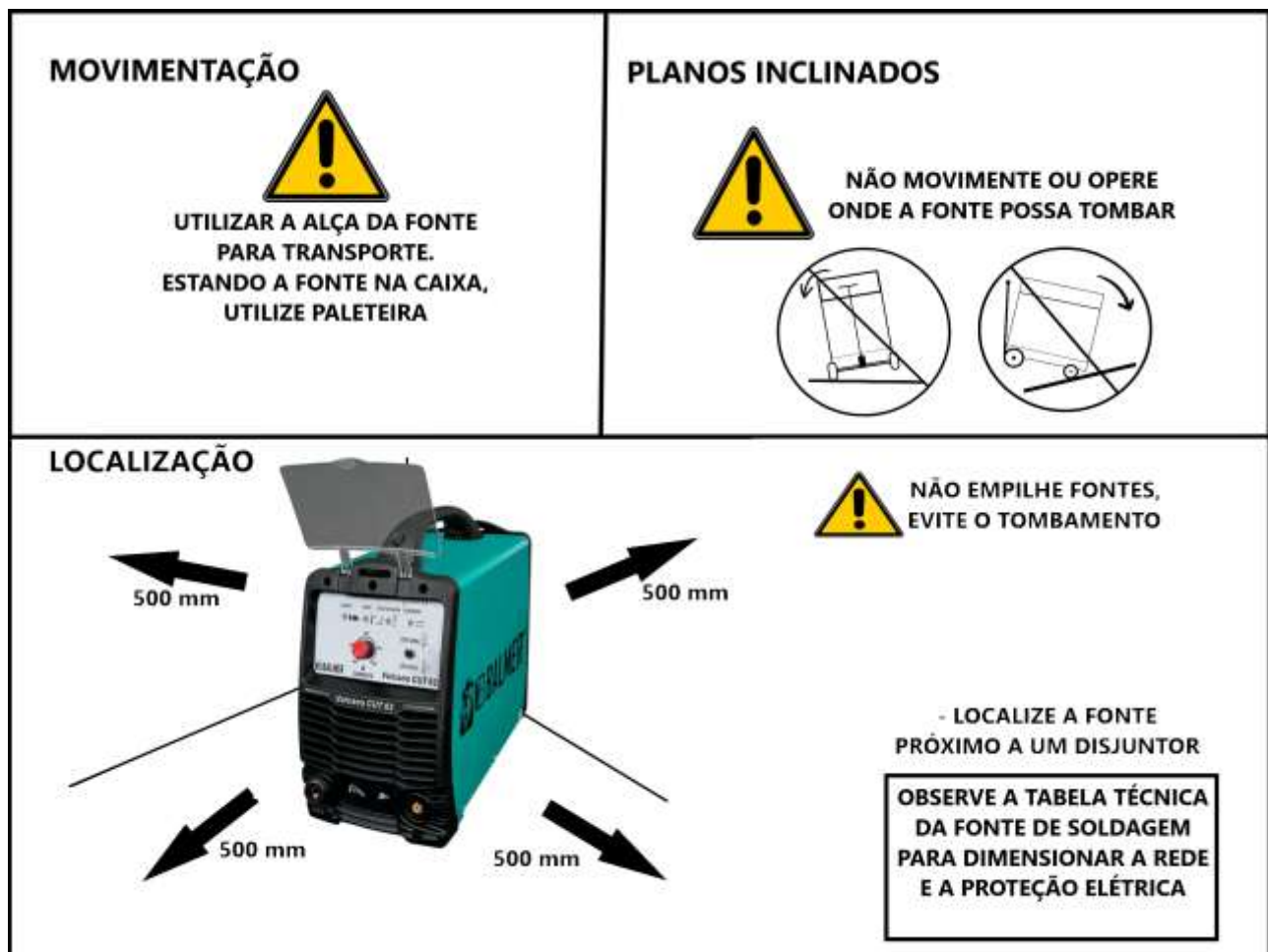
Figura 2 – Atribuições de local de instalação.
