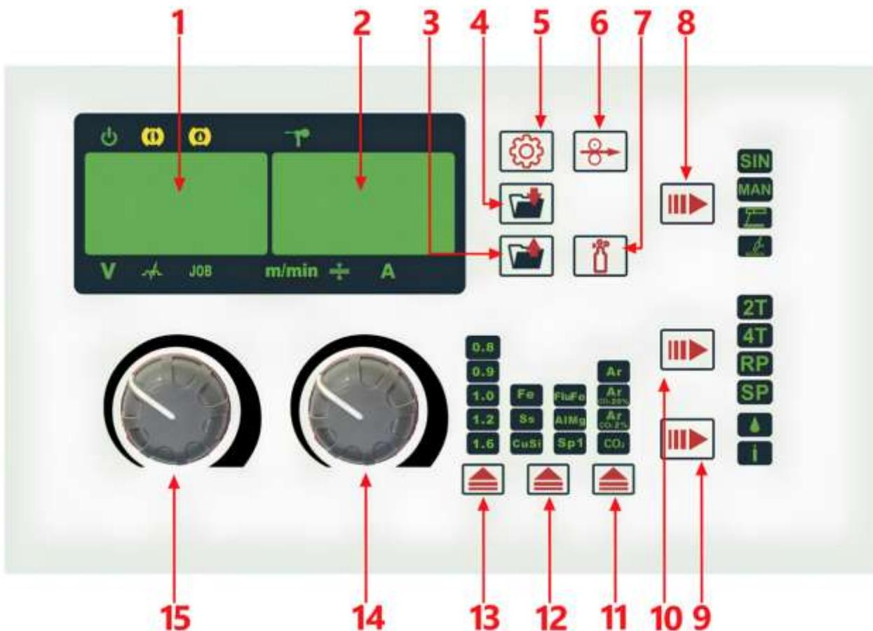
Figura 10 - Detalhe painel frontal Vulcano FLEX MIG 450i.
