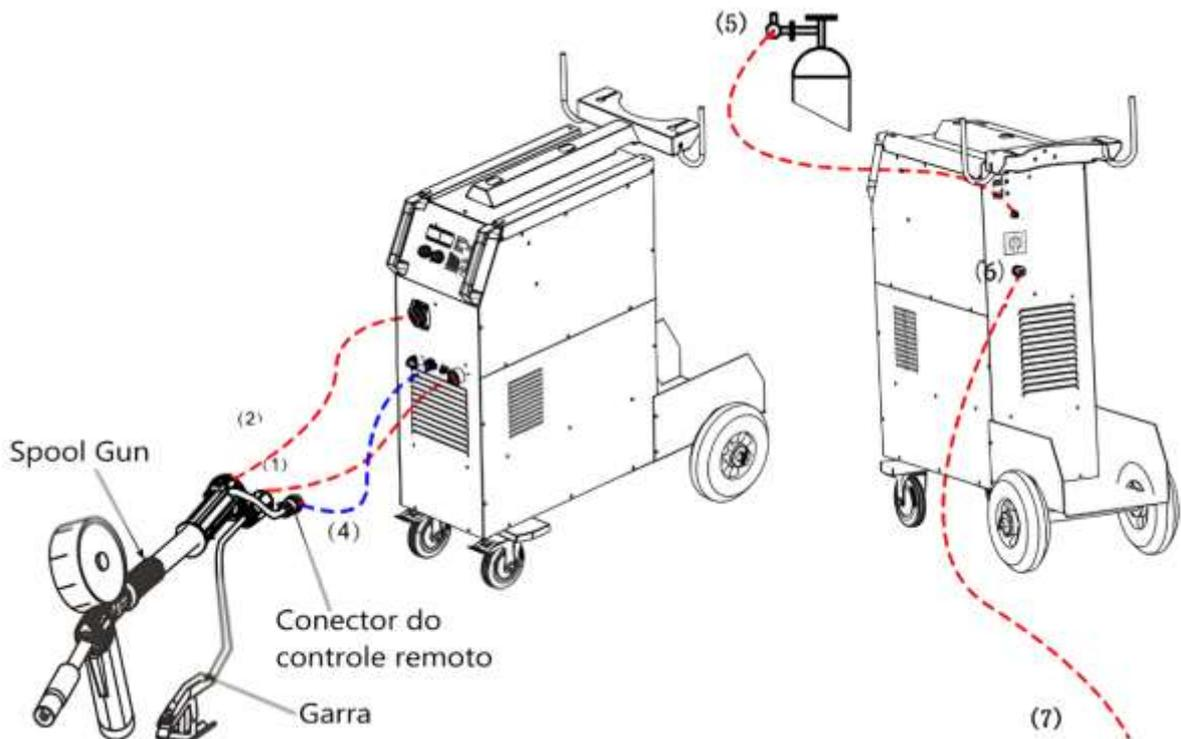
Figura 4 – Conexão tocha Spool Gun.
