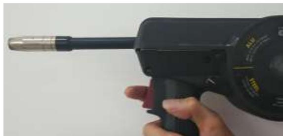
A Vulcano Flex MIG 450i conta com a possibilidade de conexão para tocha Push Pull, desde que sua conexão do gatilho esteja conforme a conexão da máquina.
