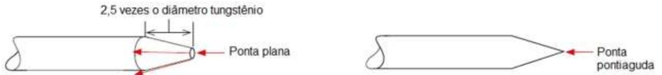
**Eletrodo com ângulo/cônico** Os eletrodos de tungstênio para soldagem CC devem ser retificados longitudinalmente e concentricamente com discos diamantados em um ângulo específico incluído em conjunto com a preparação da ponta/plana. Diferentes ângulos produzem diferentes formas de arco e oferecem diferentes capacidades de penetração de solda. Em geral, eletrodos mais rombos que possuem um ângulo maior, fornecem os seguintes benefícios:
