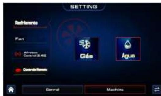
Para a configuração de tipo de arrefecimento refrigerado a água, deve-se solicitar a fonte de soldagem juntamente com a unidade de refrigeração SRB 180 SMART, conforme abaixo.
