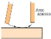
1. Movimento de mergulho do eletrodo em direção à poça de fusão de modo a manter o comprimento de arco constante. Para isto, a velocidade de mergulho deve ser igualada à velocidade de fusão do eletrodo, a qual depende da corrente de soldagem
