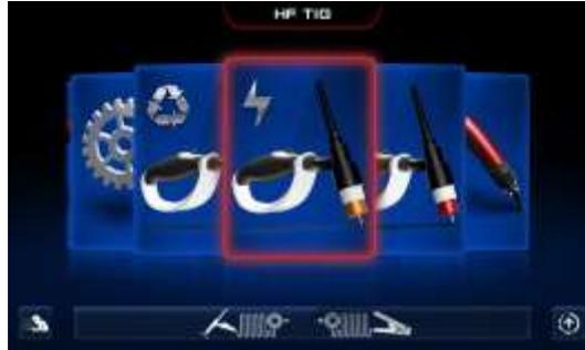
No processo TIG HF, ou TIG Alta Frequência, sem encostar o eletrodo de tungstênio na peça mantenha uma distância de 5 mm e pressione o gatilho da tocha. Um arco piloto irá se estabelecer e logo o arco de solda deve iniciar.
