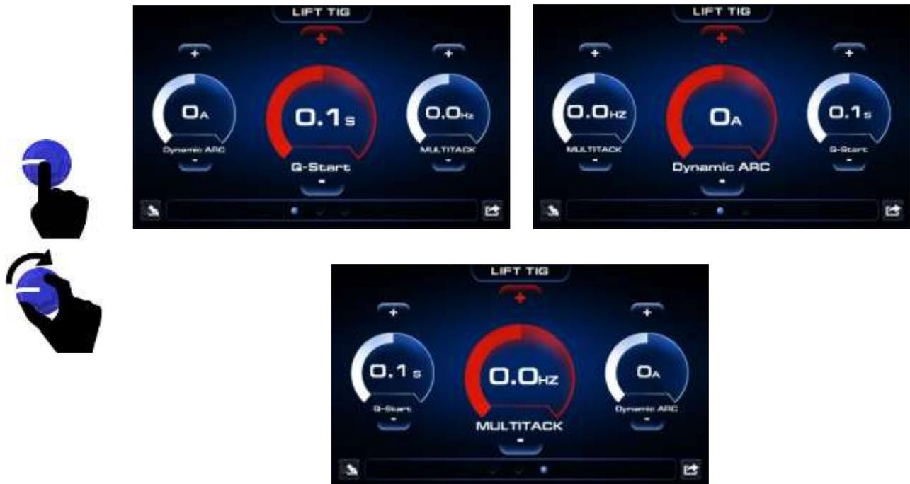
Pressione o botão direito (5) para retornar a interface inicial do processo de soldagem TIG LIFT ARC.
