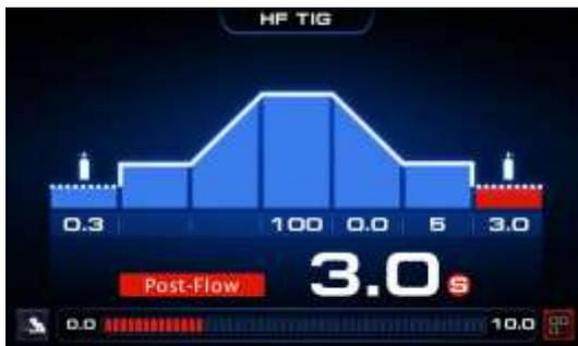
Com o encoder de ajuste (4), gire-o para alterar o valor do ponto de solda de 0,1 a 20s.
