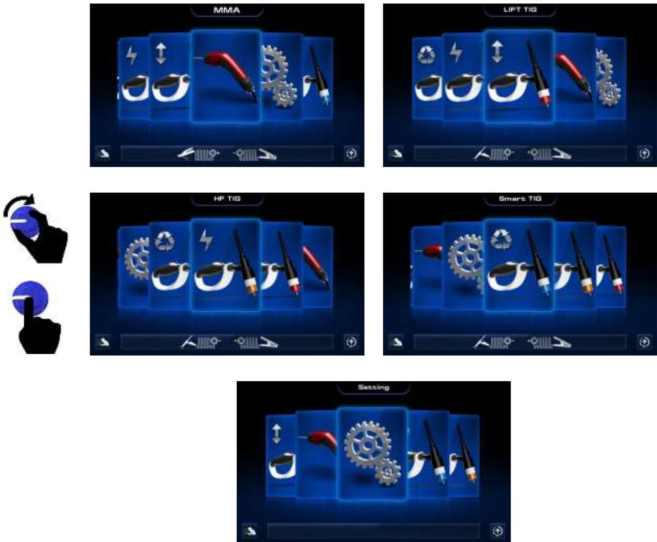
Nesta interface inicial geral, também pode-se notar na parte inferior do display LCD a configuração de polaridade necessária para cada processo.
