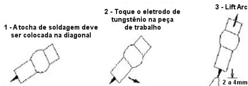
Figura 5 – Abertura de arco com LIFT ARC
