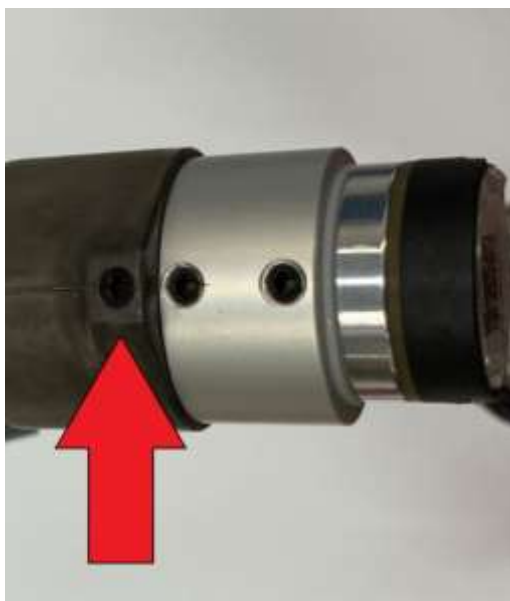
Figura 32 – Retirada da lente refletora do corpo da tocha.
