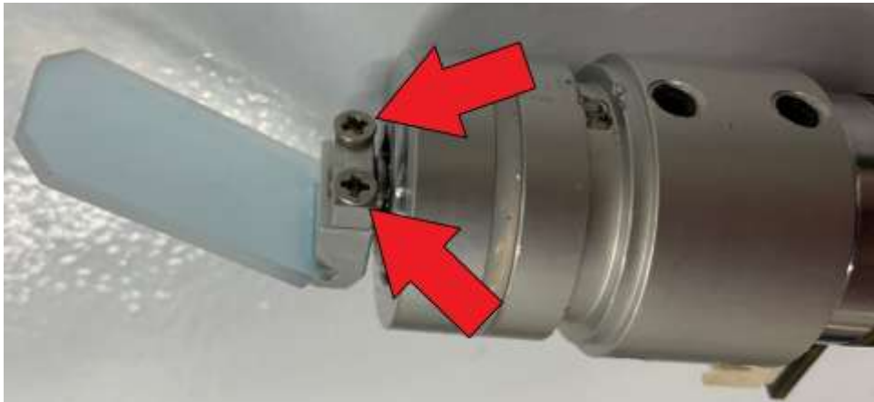
Figura 33 – Retirada dos parafusos da lente refletora.
