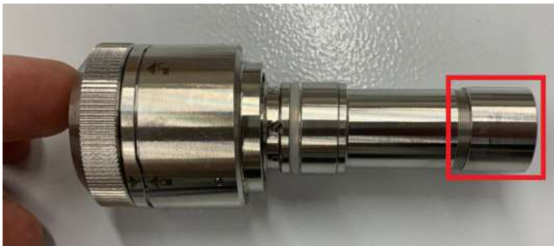
Figura 35 – Retirada do fixador da lente de colimação.
