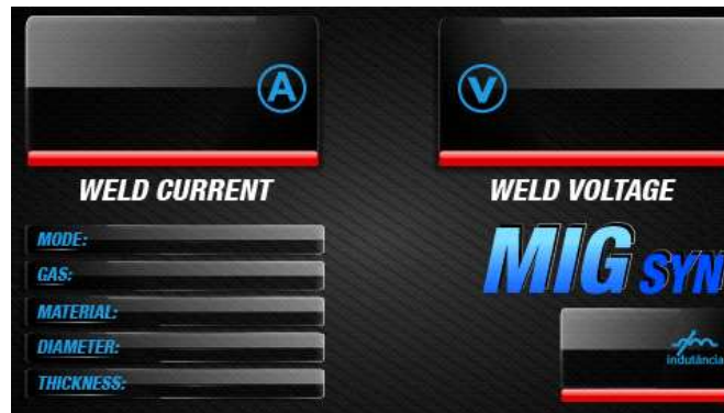
Modo MIG SYN com ajuste de corrente e tensão de solda.
