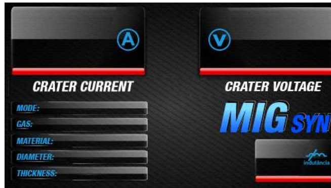
Modo MIG SYN com ajuste de corrente e tensão de cratera.
