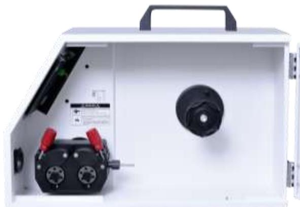
Figura 19 – Vista lateral direita do alimentador de arame externo.
