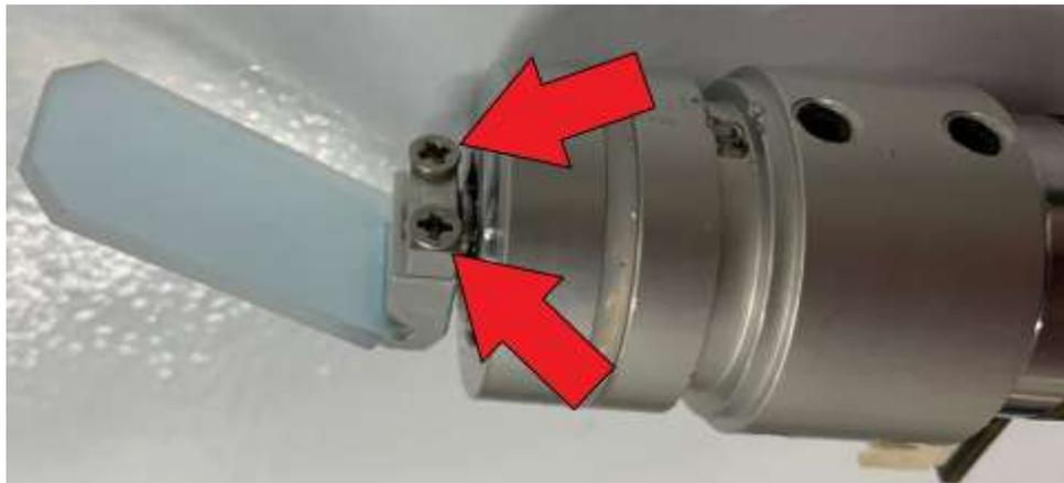
Figura 32 – Indicação dos parafusos de fixação da lente refletora.
