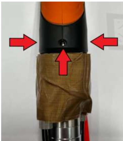
Figura 33 – Indicação de parafusos de fixação da lente de colimação.
