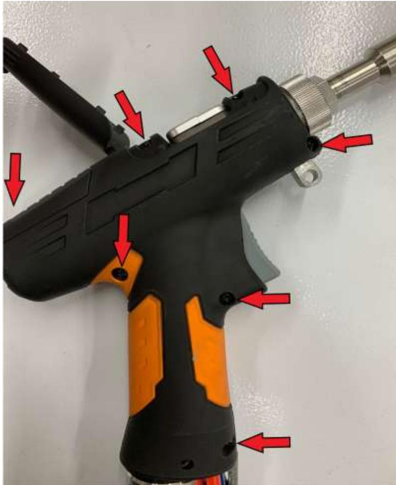
Figura 29 – Indicação de parafusos de fixação do corpo da tocha.
