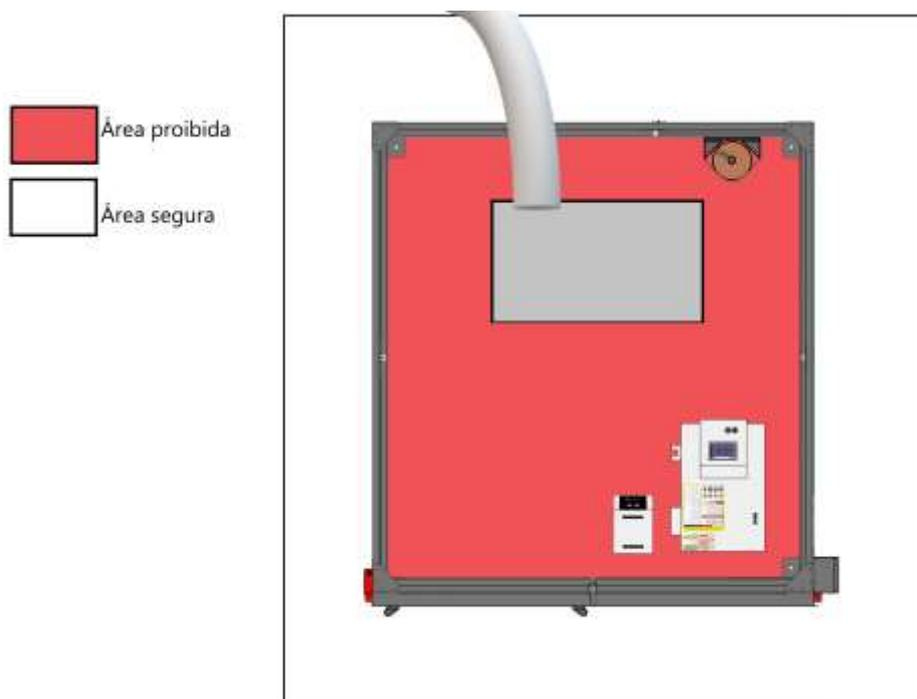
Figura 24 – Indicação de área proibida e área de operação.
