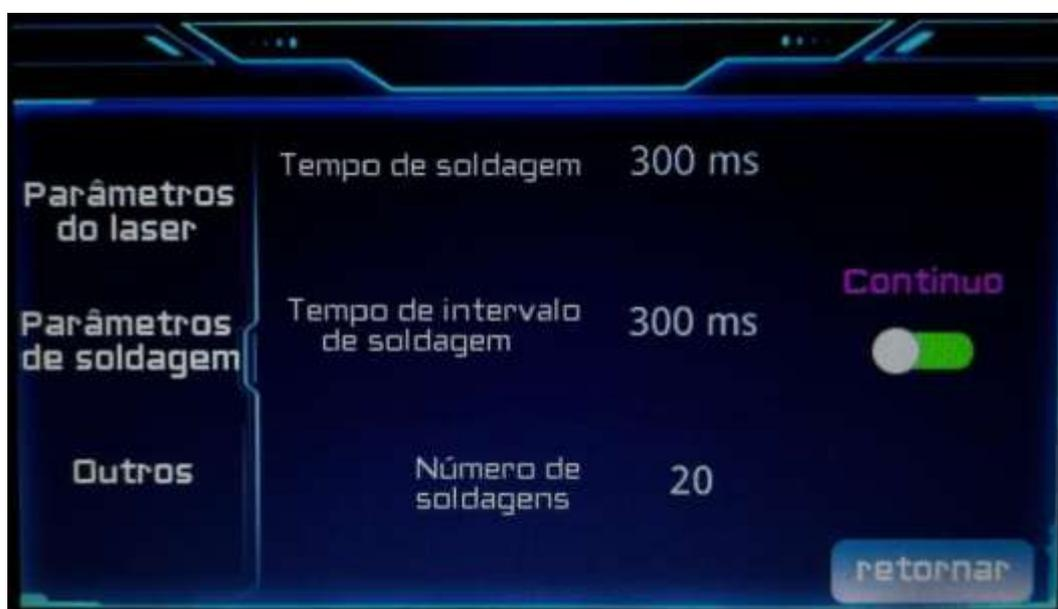
Figura 7 – Painel de parâmetros de soldagem.
