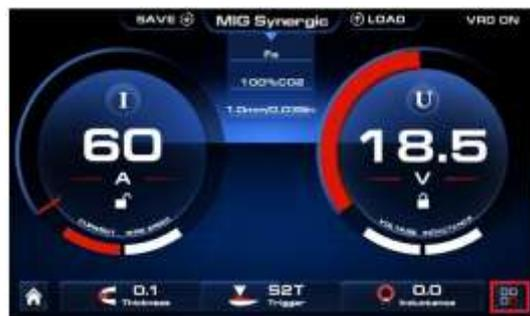
Com o encoder de ajuste (4), gire-o para alterar valores de pré gás, rampa de subida, porcentagem de corrente inicial, tempo de corrente inicial, corrente de solda, porcentagem de corrente final, tempo de corrente final, burn back e pós gás.
