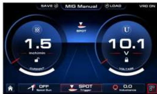
Com o encoder de ajuste (4), gire-o para alterar valor de pré gás, rampa de subida, corrente de solda, rampa de descida e pós gás.
