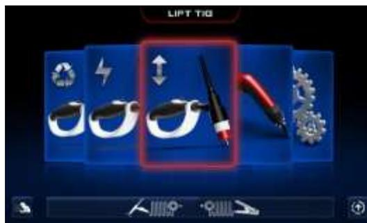
No processo TIG LIFT ARC, quando o eletrodo de Tungstênio toca a peça de trabalho, com o gatilho da tocha pressionado, é gerada uma corrente de curto-circuito de apenas 10 A. Eleve a tocha, afastando o eletrodo da peça e então o arco de solda com a corrente ajustada se estabelecerá, conforme imagem abaixo.
