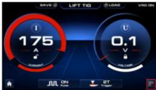
Com o encoder de ajuste (4), ajuste os valores de pré gás, corrente inicial, rampa de subida, corrente principal, rampa de descida, corrente final e pós gás, conforme abaixo.
