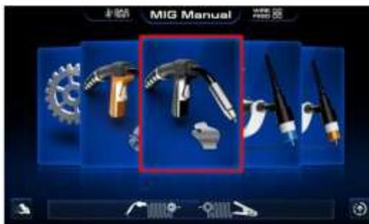
Na função MIG/MAG manual altere a velocidade de alimentação de arame e tensão, assim como demais parâmetros disponíveis neste modo de soldagem.
