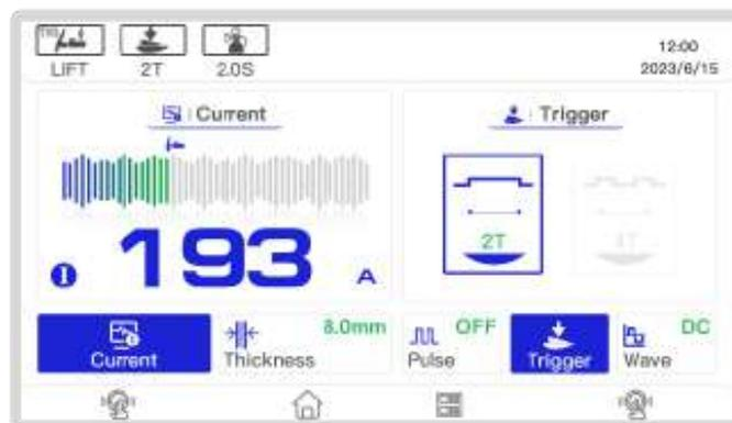
A Vulcano Flex Pulse 505i possui ajustes de pós gás de 0 a 20 s, rampa de descida de 0 a 20 s e tipos de acionamento de 2T, 4T e S4T. Para ajustá-los, gire os encoders para selecionar, aperte-o para entrar em configuração e altere com os encoders o valor desejado.
