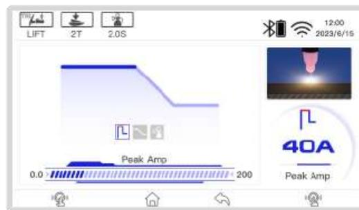
Após a ignição do arco elétrico, a corrente de soldagem sobe até ao valor ajustado pelo operador. Se durante a soldagem o eletrodo de Tungstênio tocar a peça, a corrente será imediatamente reduzida, diminuindo assim a deterioração e prolongando a vida útil do eletrodo.
