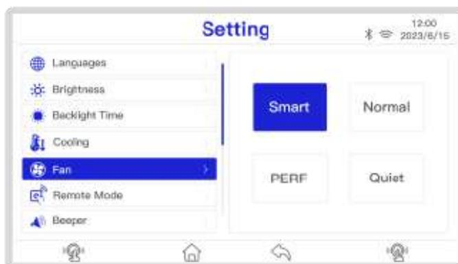
Para desativar a função de arrefecimento a água, ou seja, o funcionamento da unidade de refrigeração quando utilizada a tocha seca, acesse as configurações de “Cooling”.
