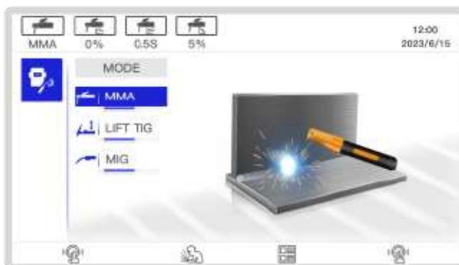
Os parâmetros de soldagem e seus ajustes correspondentes devem ser selecionados e alterados com os encoders de ajuste 7 e 8, conforme imagem abaixo.
