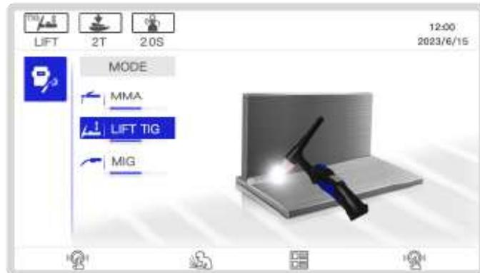
Para o processo TIG, pressione o encoder de ajuste e gire para ajustar os parâmetros de soldagem, conforme abaixo.
