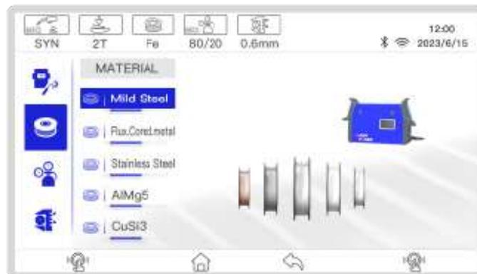
Efetuada a escolha do material será direcionado para a escolha do gás a ser utilizado para a soldagem, dentre as opções: Mix Gás (gás mistura) ou CO2 (Gás Dióxido de Carbono). Para os outros materiais, não será possível realizar a escolha do gás.
