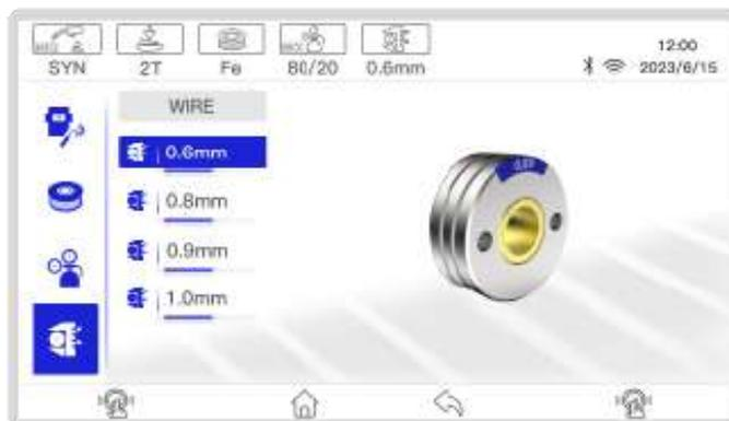
Definida a bitola do arame, conforme a espessura do material conforme tabela de referência abaixo. Assim que o diâmetro desejado estiver seccionado, pressione encoder para confirmar.
