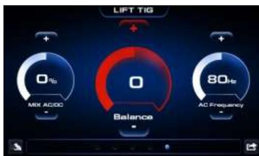
Para retornar a interface de soldagem LIFT ARC, pressione brevemente o botão esquerdo (2).
