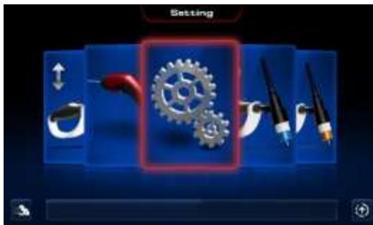
Aperte o botão direito (5) para alternar entre configuração geral ou configuração de interface da fonte de soldagem.
