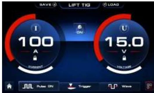
Com o encoder de ajuste (4) pressione para selecionar o parâmetro a ser alterado e gire-o para alterar os valores de pré gás, corrente inicial, rampa de subida, corrente de pico, corrente de base, percentual de corrente de base (taxa de serviço), frequência AC, rampa de descida, corrente final e pós gás conforme abaixo.
