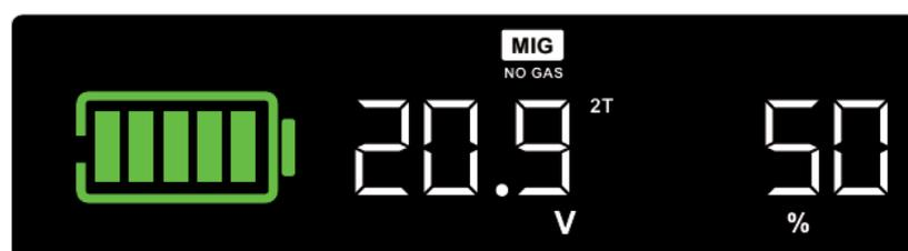
Figura 19 – Ajuste fino de tensão.
