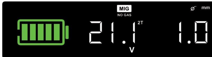
Figura 17 – Ajuste do diâmetro de arame.
