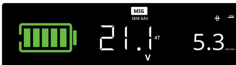
Figura 16 – Modo de acionamento MIG (FCAW) 4T.
