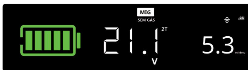
Figura 15 – Modo de acionamento MIG (FCAW) 2T.
