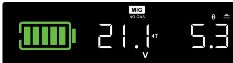
Figura 18 – Ajuste da velocidade de arame.
