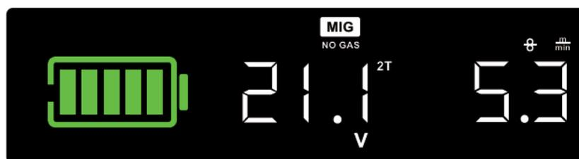
Figura 13 – Exibição do display durante os ajustes para soldagem MIG (FCAW).
