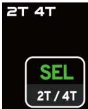
**Botão de ajuste de 2T e 4T:** quando pressionado, é possível alterar o modo de inicialização e finalização do corte entre 2 T (aperte para iniciar o corte, solte para parar o corte) ou 4T (aperte e solte para iniciar o corte, aperte e solte para parar o corte).
