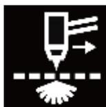
**Modo de corte de grade:** quando selecionado, através do botão de seleção de modo, é configurado o modo de corte de grade. Esse método é ideal para que em cortes de chapas com elevado número de furações o arco de corte não se mantenha contínuo, assim reconhecendo onde há material para cortar.
