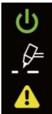
**Indicação de fonte energizada e ligada:** aparente quando a fonte de corte a plasma está energizada, ligada e pronta para a operação;
