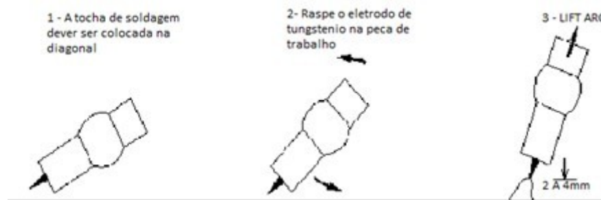
Figura 11 - modo de abertura de arco TIG lift arc
