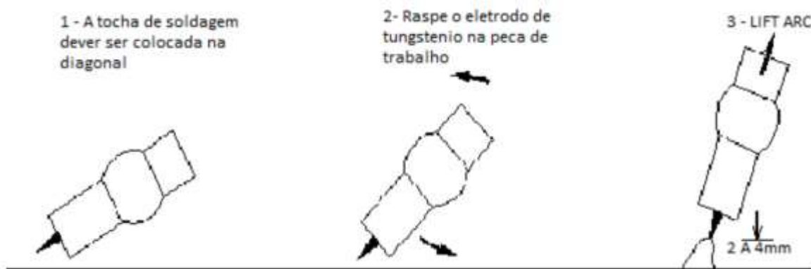
Figura 7 – Método para abertura de arco com Lift Arc.
