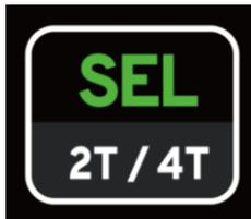
**Botão de ajuste de 2T e 4T:** quando pressionado, é possível alterar o modo de inicialização e finalização do corte entre 2T (aperte para iniciar o corte, solte para parar o corte) ou 4T (aperte e solte para iniciar o corte, aperte e solte para parar o corte).
