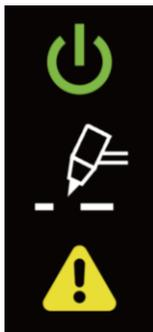
**Indicação de fonte energizada e ligada:** aparente quando a fonte de corte a plasma está energizada, ligada e pronta para a operação;
