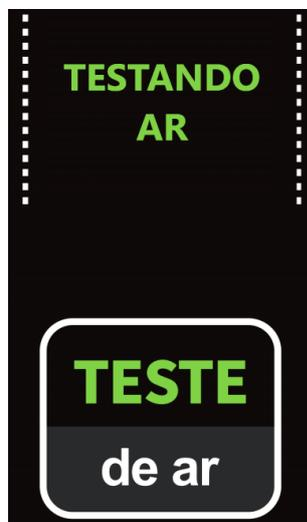
**Botão de teste de ar:** quando pressionado, a válvula solenoide traseira é aberta e é possível fazer o teste de gás. Quando estiver pressionado, a indicação de “Gas checking” é aparente no painel até que o botão seja solto.
