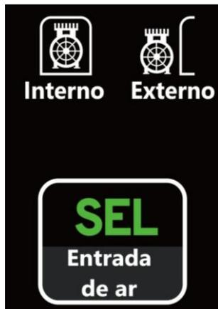
**Botão de seleção de entrada de ar:** quando pressionado, é possível alterar a forma de alimentação de ar da tocha, podendo ser “internal” (compressor da máquina) ou “external” (compressor externo);
