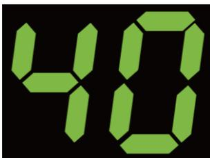
**Indicação de corrente:** Regulada pelo potenciômetro de ajuste de corrente, tem como faixa de ajuste de 10 a 40 A.
