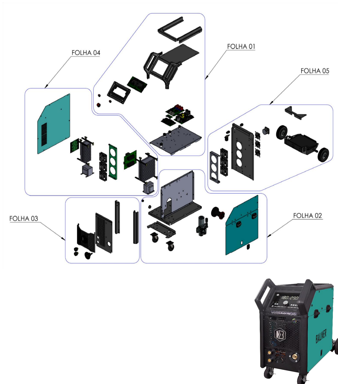
Figura 12 – Vista explodida geral.
