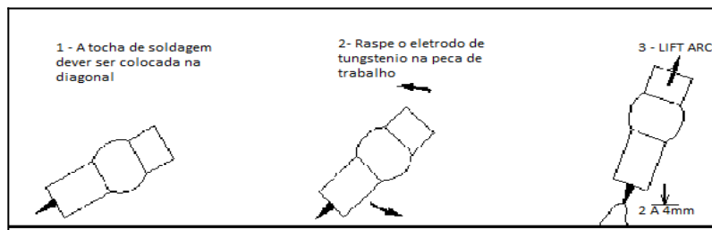
Figura 5- Método para abertura de arco com LIFT ARC
