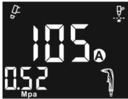
Figura 11 - Unidade de medida da pressão do gás em Mpa.
