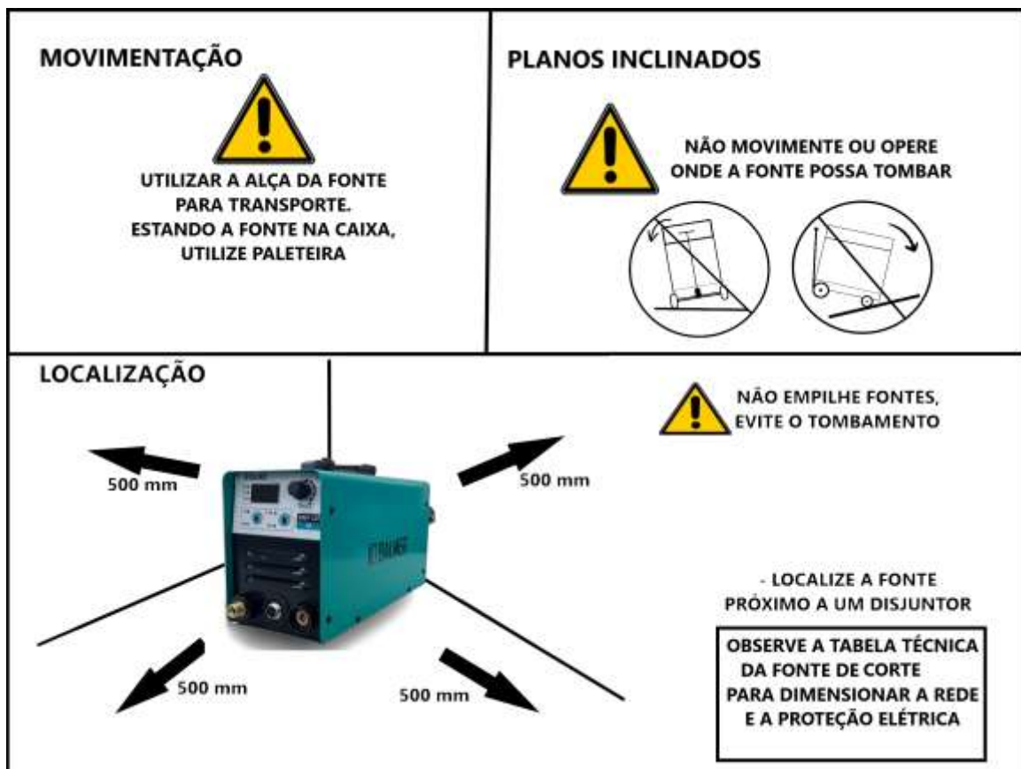
Figura 1 – Atribuição do local de instalação Easy CUT 40.
