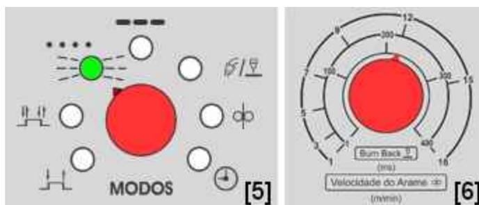
Ligando a fonte de soldagem com a tecla “SET” (CH2 – face traseira da placa) pressionada e o Potenciômetro de Modos [5] apontado para a função **Ponteamento**, o LED associado irá piscar. Através do *Potenciômetro velocidade do arame e Burn Back* [6], o operador definirá o tipo de alimentador:
