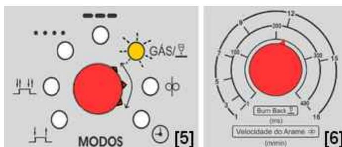
Ligando a Fonte de soldagem com o gatilho pressionado e o Potenciômetro de Modos [5] apontado para o lado direito da escala (função: Teste gás, Inserção de arame ou Ajuste tempos), o LED de indicação de *Burn Back* começará a piscar. Através do *Potenciômetro velocidade do arame e Burn Back* [6], o operador definirá o tempo de *Burn Back*. Para finalizar, deve-se pressionar o gatilho da tocha novamente.
