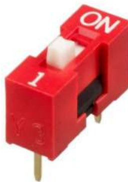
Figura 6 – Chave DIP para VRD ON/OFF.
