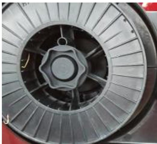
**(3)** Ajustar a bobina de arame no suporte da bobina encaixando a cavilha de posicionamento dentro do furo menor do carretel. Recoloque a porca do eixo carretel.
