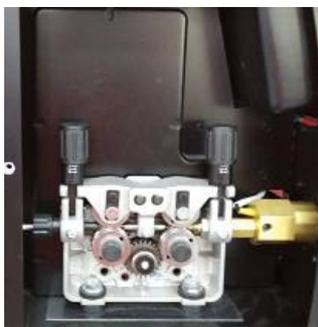
(7) Verifique se o fio passa pelo centro do tubo guia de saída sem tocar nos lados. Desaperte o parafuso de trava e, em seguida, desaperte a porca de retenção do tubo guia de saída, se necessário. Volte a apertar cuidadosamente a porca de fixação e o parafuso para prender a nova posição.
