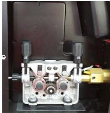
(5) Passe o fio pelo rolete de tração e pelo tubo guia de saída do alimentador de arame.
