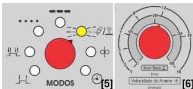
Ligando a Fonte de soldagem com a tecla “SET” (CH2 – face traseira da placa) pressionada e o Potenciômetro de Modos [5] apontado para a função **Teste de gás**, o LED associado irá piscar. Através do *Potenciômetro velocidade do arame e Burn Back* [6], o operador definirá se a placa será controlada por tecla ou por potenciômetro:
