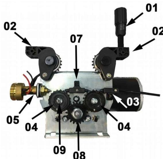
Solte o parafuso de pressão [1] e levante o conjunto braço de pressão [2] do alimentador.
