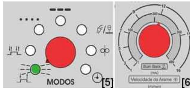
Ligando a fonte de soldagem com a tecla “SET” (CH2 – face traseira da placa) pressionada e o Potenciômetro de Modos [5] apontado para a função **2 Passos**, o LED associado irá piscar. Pressionando o gatilho e mantendo pressionado o ajuste de velocidade mínima poderá ser feito através do Potenciômetro velocidade do arame e Burn Back [6], quando chegar à velocidade desejada soltar o gatilho e pressionar novamente. Todos os LED's irão acender por um segundo indicando a gravação.
