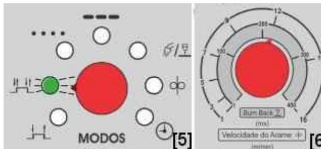
Ligando a Fonte de soldagem com a tecla “SET” (CH2 – face traseira da placa) pressionada e o Potenciômetro de Modos [5] apontado para a função **4 Passos**, o LED associado irá piscar. Pressionando o gatilho e mantendo pressionado o ajuste de velocidade máxima poderá ser feito através do Potenciômetro velocidade do arame e Burn Back [6], quando chegar à velocidade desejada soltar o gatilho e pressionar novamente. Todos os LED's irão acender por um segundo indicando a gravação.
