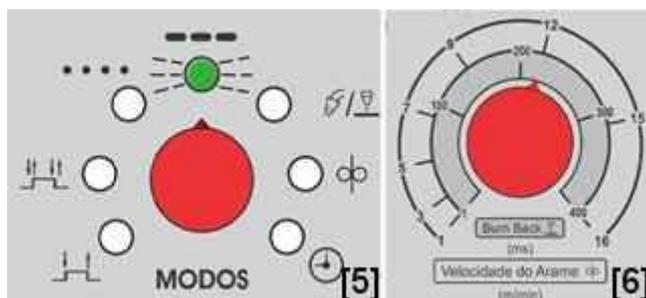
Ligando a Fonte de soldagem com a tecla “SET” (CH2 – face traseira da placa) pressionada e o Potenciômetro de Modos [5] apontado para a função **Intermitente**, o LED associado irá piscar. Através do *Potenciômetro velocidade do arame e Burn Back* [6], o operador definirá o modelo da máquina:
