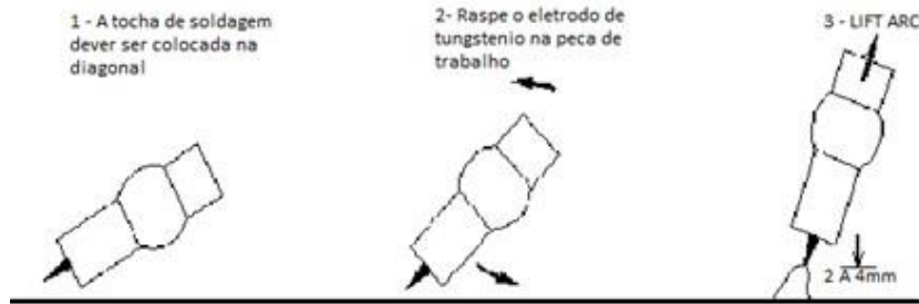
Figura 16 - modo de abertura de arco TIG lift arc
