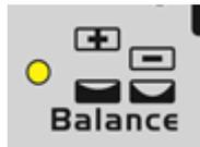
O ajuste de balanço é utilizado para definir a largura da eliminação de óxido de metal da superfície a ser soldada (na soldagem com corrente alternada – AC – de alumínio, magnésio e suas ligas).
