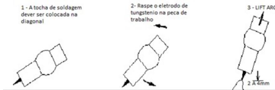
Figura 10 – Modo de abertura de arco com LIFT ARC
