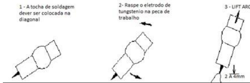
Figura 7 – Modo de abertura de arco com LIFT ARC.
