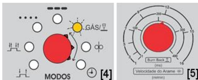
Ligando a Fonte de soldagem com o gatilho pressionado e o Potenciômetro de Funções [4] apontado para o lado direito da escala (função: Teste gás, Inserção de arame ou Ajuste tempos), o LED de indicação de *Burn Back* começará a piscar. Através do Potenciômetro velocidade do arame e *Burn Back* [5], o operador definirá o tempo de *Burn Back*. Para finalizar, deve-se pressionar o gatilho da tocha novamente.
