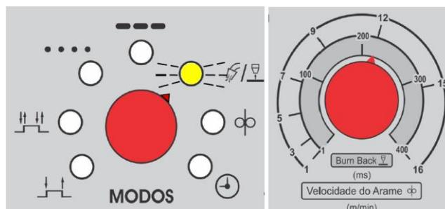
Ligando a Fonte de soldagem com a tecla “SET” (CH2 – face traseira da placa) pressionada e o Potenciômetro de Modos [4] apontado para a função **Teste de gás**, o LED associado irá piscar. Através do *Potenciômetro velocidade do arame e Burn Back* [5], o operador definirá se a placa será controlada por tecla ou por potenciômetro:
