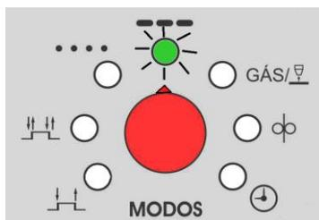
Da mesma forma que na função anterior (Ponteamento), será necessário um pré-armazenamento de “tempo de solda” e “intervalo de solda” (detalhado no item 4.3.7).
