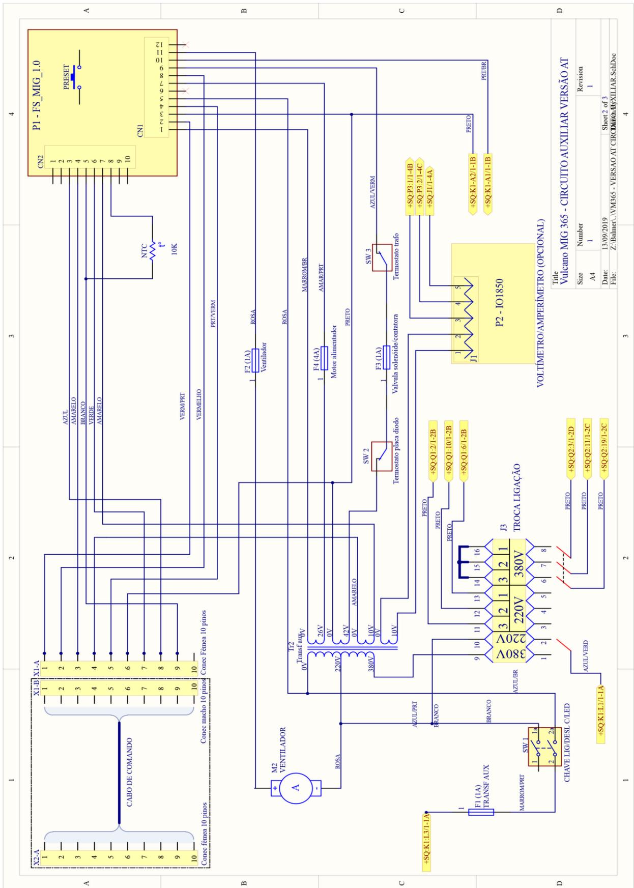
Figura 5 – Diagrama elétrico Vulcano MIG 365 – circuito auxiliar
