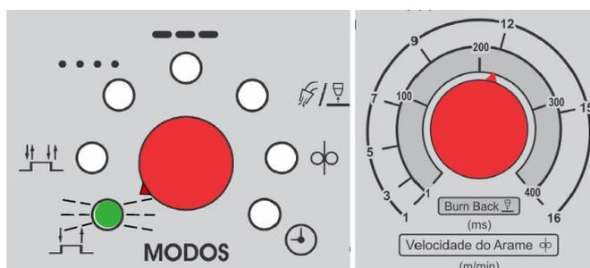
Ligando a fonte de soldagem com a tecla “SET” (CH2 – face traseira da placa) pressionada e o Potenciômetro de Modos [4] apontado para a função **2 Passos**, o LED associado irá piscar. Pressionando o gatilho e mantendo pressionado o ajuste de velocidade mínima poderá ser feito através do Potenciômetro velocidade do arame e Burn Back [5], quando chegar à velocidade desejada soltar o gatilho e pressionar novamente. Todos os LED's irão ascender por um segundo indicando a gravação.
