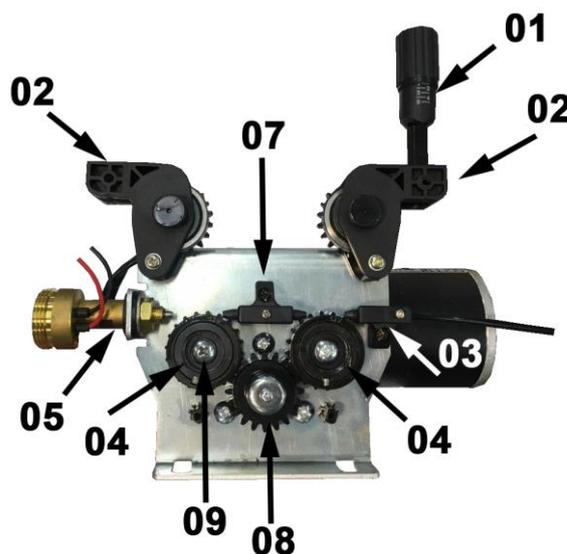
Solte o parafuso de pressão [1] e levante o conjunto braço de pressão [2] do alimentador.
