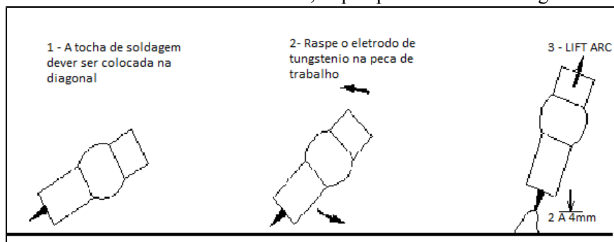
Figura 5- Método para abertura de arco com LIFT ARC
