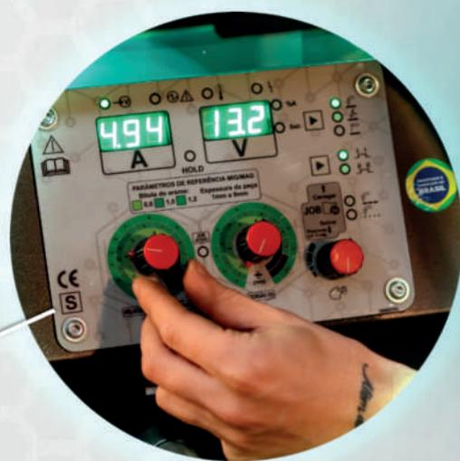
Display Digital: com informações de corrente, velocidade de arame, tensão e tempo de solda.
