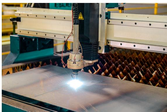
Sistema de anti-colisão que desliga automaticamente o corte em caso de colisão da tocha.
