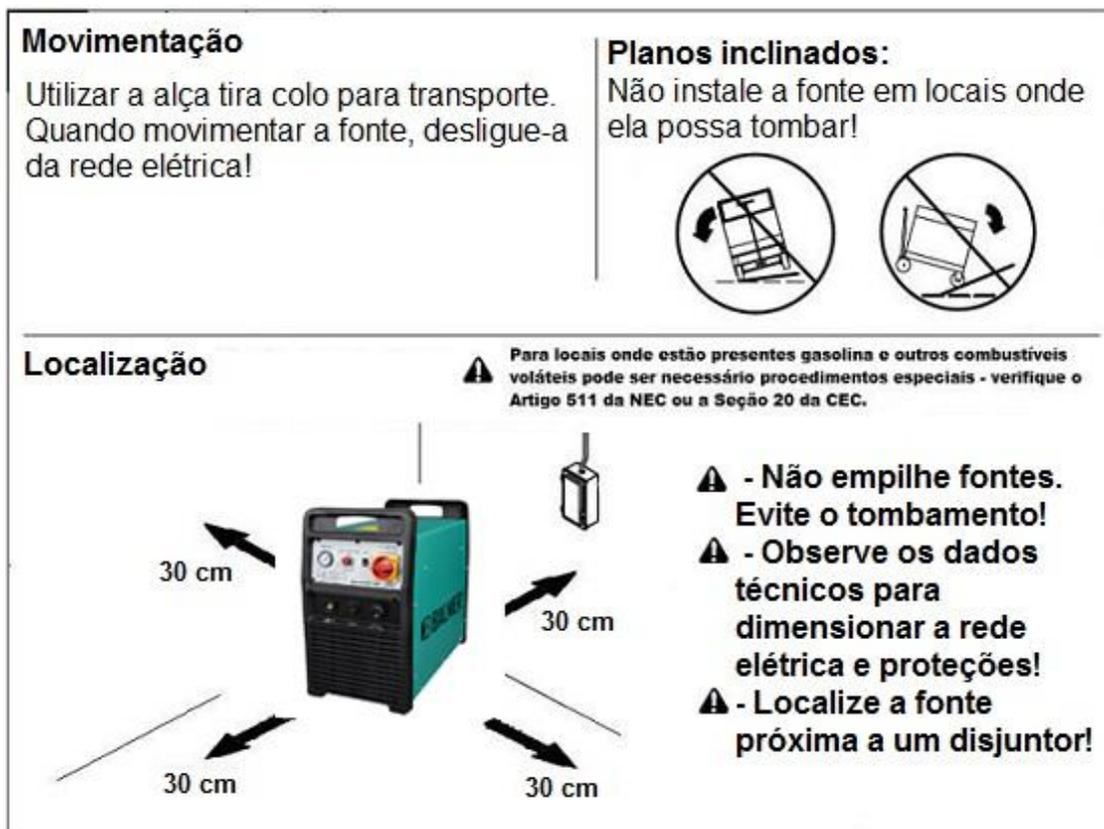
Figura 2 – Orientações gerais de instalação da máquina
