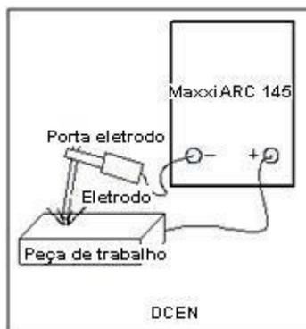
Figura 3 - Conexão negativa para soldagem com eletrodo revestido
