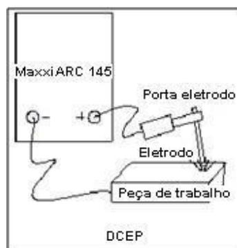
Figura 4 - Conexão positiva para soldagem com eletrodo revestido
