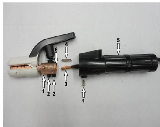
**ATENÇÃO:** Manter garra negativa e/ou porta-eletrodo em más condições, com mau contato ou ainda substituir por outro dispositivo de contato não apropriado pode danificar a fonte de soldagem e resultar em perda da garantia!
