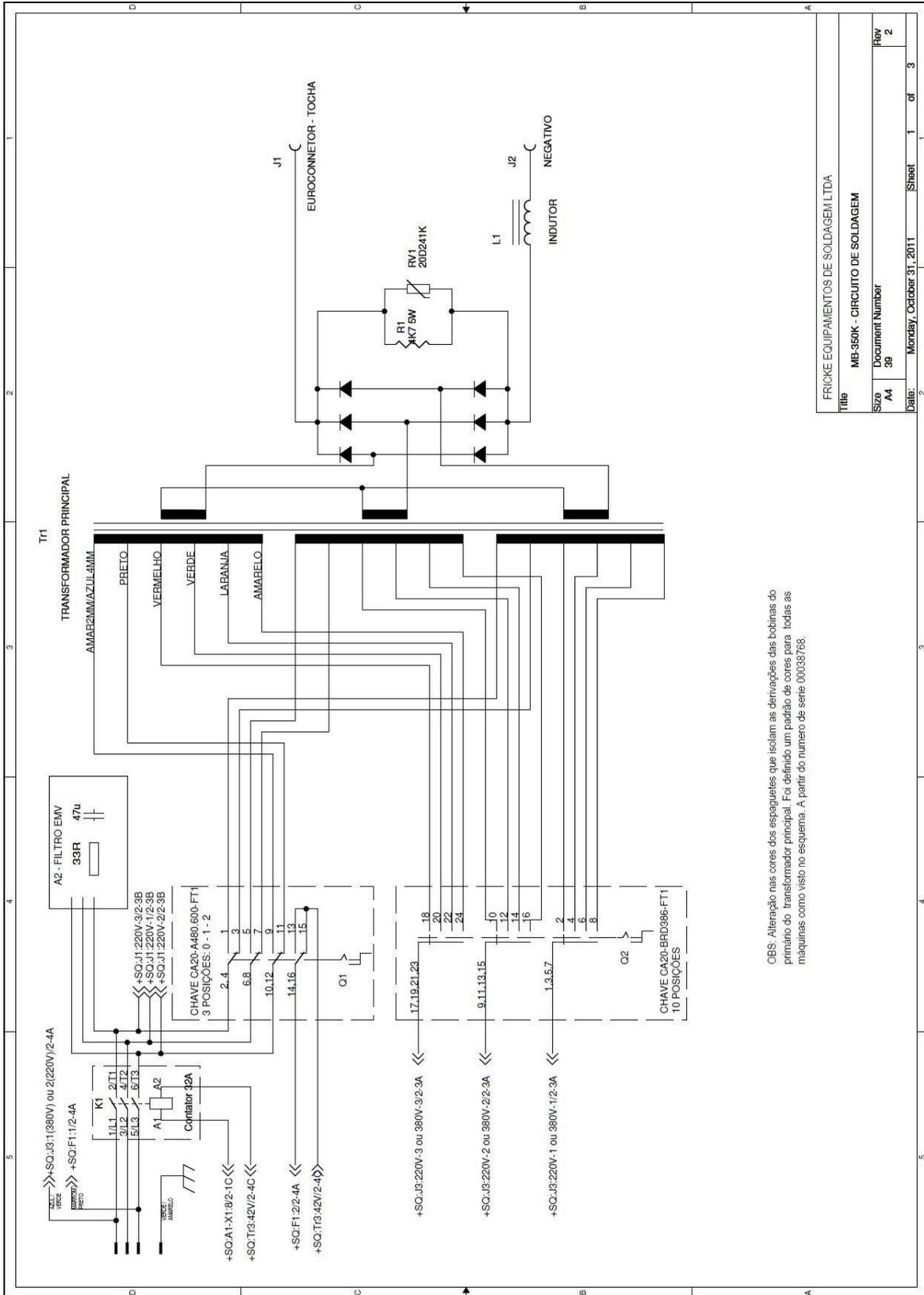
OBS: Alteração nas cores dos espaguetes que isolam as derivações das bobinas do primário do transformador principal. Foi definido um padrão de cores para todas as máquinas como visto no esquema. A partir do número de série 00038768.
