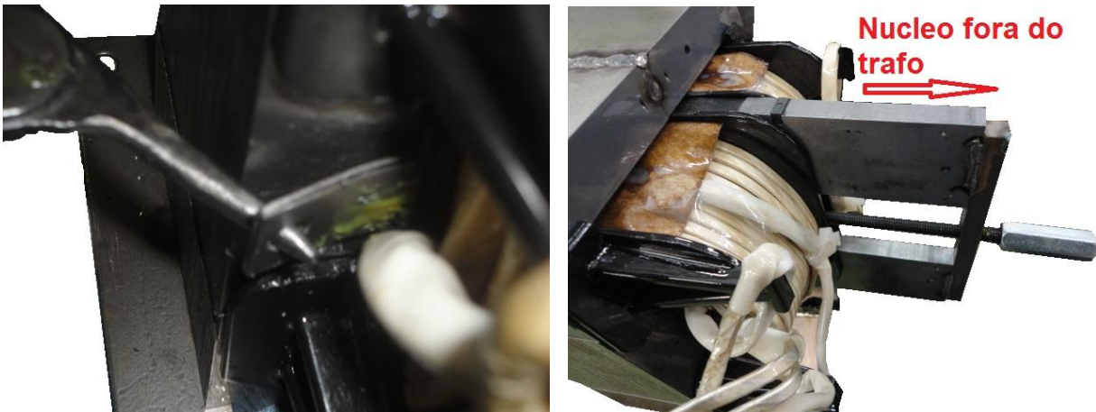
Figura 2 - Método de retirada da Chapa Trava Fuso
